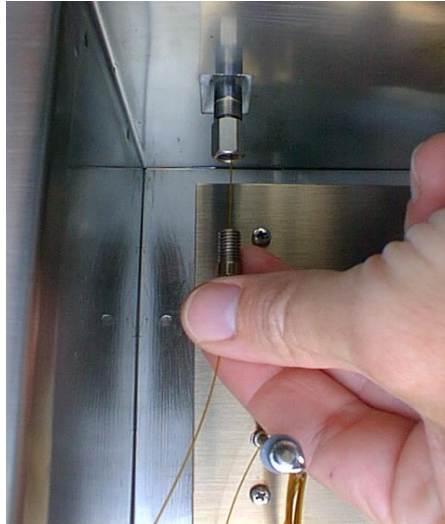
Abb. 37: Einbau der Säule an der Injektorseite
